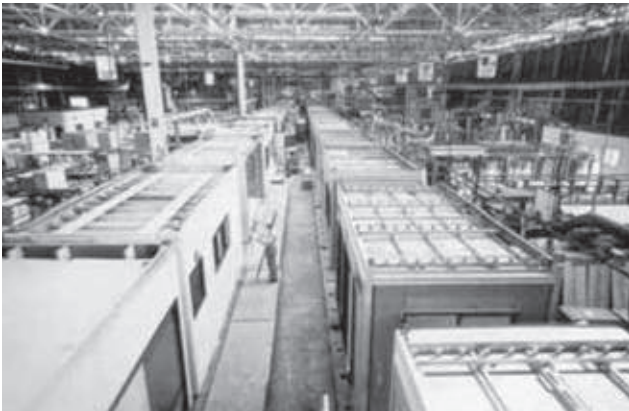
Foto 2.3 - Linha de montagem de módulos residenciais no Japão (Fonte: Sel)
