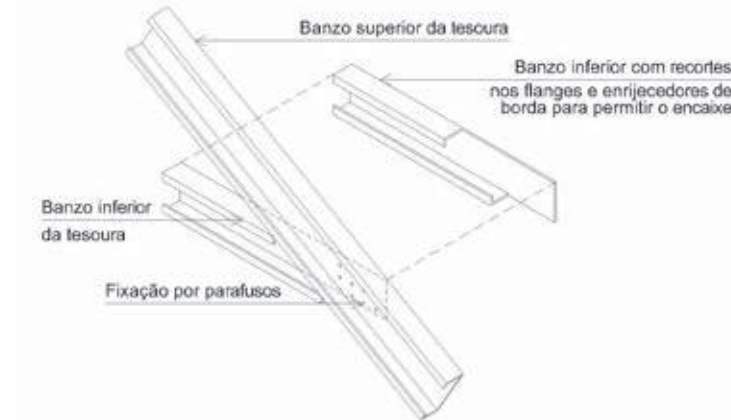
Figura 5.15 - Detalhe da união do banzo superior e inferior de uma tesoura
